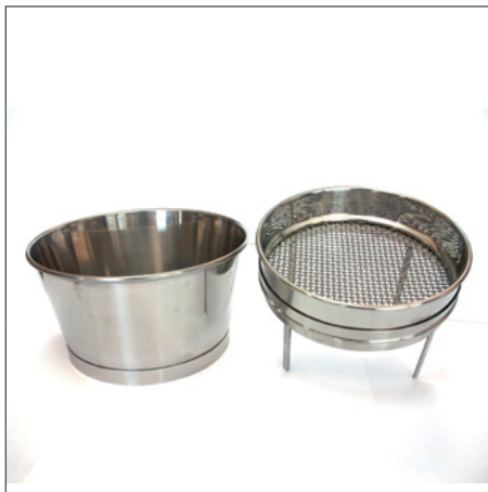
Tamices especiales: cónicos, doble altura, media altura, para pesos escurridos, etc.
