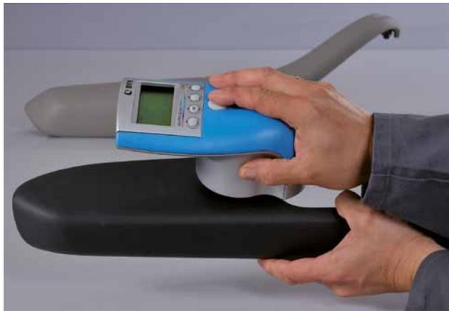
La nueva familia spectro-guide S ofrece una mejora técnica para el brillo a 60° en el rango inferior de 0 - 10 UB. Se garantiza una excelente repetibilidad de  $\pm 0.1$  UB, gracias a su proceso patentado de calibración. Además, el espectrofotómetro spectro-guide S, ofrece ventajas únicas que garantizan resultados precisos:
