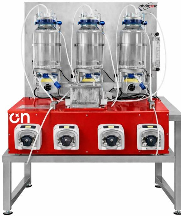
La Planta Piloto de Biogás es un equipo didáctico controlado desde un ordenador, diseñado para el estudio y la comprensión del proceso de digestión anaerobia y la producción de biogás.
