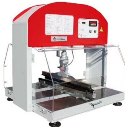
Dotación: Célula de carga de 800Kg con cuchilla. Software y cable RS232/USB para PC
